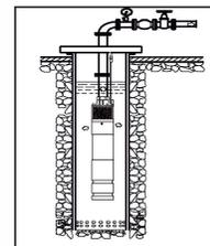
5. Перекачиваемая жидкость может быть под высоким давлением, поэтому прежде чем демонтировать насос, перекройте элементы запорной арматуры на напорном трубопроводе, чтобы избежать возможных травм!
