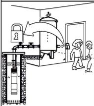
3. Не торкайтеся до електричних частин насоса під час роботи. Заборонено митися, плавати поблизу робочої зони, щоб уникнути нещасних випадків.
