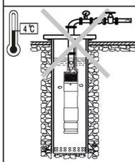
4. В случае падения температуры окружающей среды ниже +4°C, или в случае длительного простоя насоса, гидросистема может быть повреждена - может произойти разрыв системы водоснабжения замерзшей водой. Чтобы избежать размораживания системы водоснабжения, необходимо утеплить трубопровод и часть скважины (колодца) на глубину не менее 1 метра.
