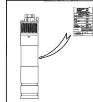
7. Параметры сети питания должны соответствовать значениям параметров, указанным на табличке корпуса электронасоса. При длительном хранении поместите насос в сухое, вентилируемое и прохладное место при комнатной температуре.
