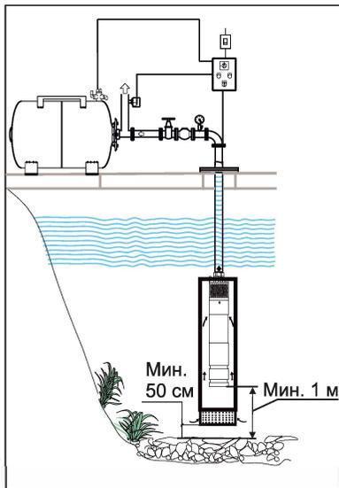
6. При определении глубины погружения насоса перед монтажом напорного трубопровода с помощью пластмассовых труб необходимо учитывать возможность растягивания (удлинения) этих труб под нагрузкой.
