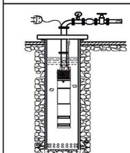
2. Электрический насос должен иметь надежное заземление для предотвращения поражения электрическим током. Для безопасности насос и цепь электропитания рекомендуем оснастить устройством защитного отключения (УЗО). Не мочить штепсель сетевого шнура.
