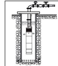
5. Рідина, що перекачується, може бути під високим тиском, тому перш, ніж демонтувати насос, перекрийте елементи запірної арматури на напірному трубопроводі, щоб уникнути можливих травм!
