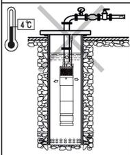
4. У випадку падіння температури навколишнього середовища нижче +4°C, або в разі тривалого простою насоса, гідросистема може бути пошкоджена - може відбутися розрив системи водопостачання замерзлою водою. Щоб уникнути розморожування системи водопостачання, необхідно утеплити трубопровід і частину свердловини (колодязя) на глибину не менше 1 метра.
