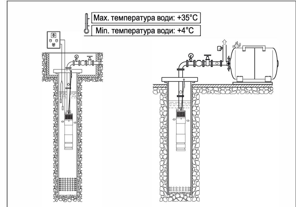
1. При монтажі насоса напірна труба повинна бути настільки короткою, наскільки можливо з найменшою кількістю вигинів. Електричний блок керування насосом повинен бути встановлений з умовою забезпечення належного перекриття для запобігання негативного впливу погодних умов.
