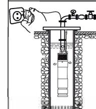
6. Слідкуйте, щоб насос несподівано не увімкнувся при монтажі або демонтажі, в цьому випадку і при тривалому простої електронасоса завжди тримайте мережевий тумблер вимкненим, а елементи запірної арматури на напірному трубопроводі - закритими.
