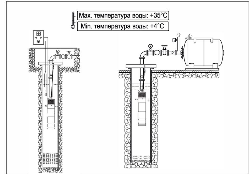
1. При установке насоса напорная труба должна быть настолько короткой, насколько возможно с наименьшим количеством изгибов. Электрический блок управления насосом должен быть установлен с условием обеспечения надлежащего перекрытия для предотвращения негативного влияния погодных условий.
