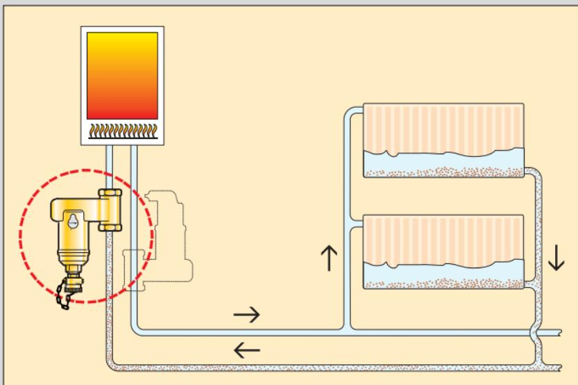
толщину 100 мкм. Современное отопительное оборудование, например, котлы с маленьким объемом воды или насосы с керамическими подшипниками, очень восприимчивы к загрязнениям в воде.
