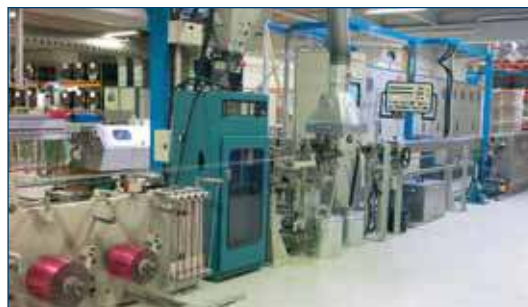
Автоматизированное производство нагревательных кабелей
