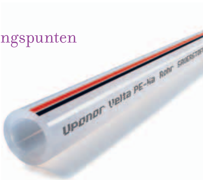
Uponor Velta PE-Xa leiding volgens procédé Engel in de afmetingen 14 x 2 mm tot 17 x 2 mm: licht, buigzaam, veilig en snel gemonteerd
