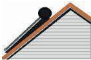
Геліоприймач, встановлений на похилій покрівлі.
