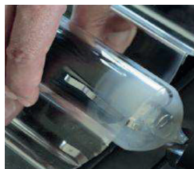
газопоглинач зруйнований, трубка несправна
