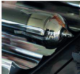
газопоглинач у порядку, трубка справна
