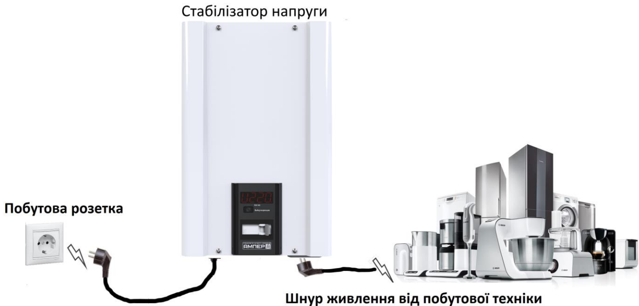
Рисунок 13. Підключення стабілізатора 5-16А до мережі
