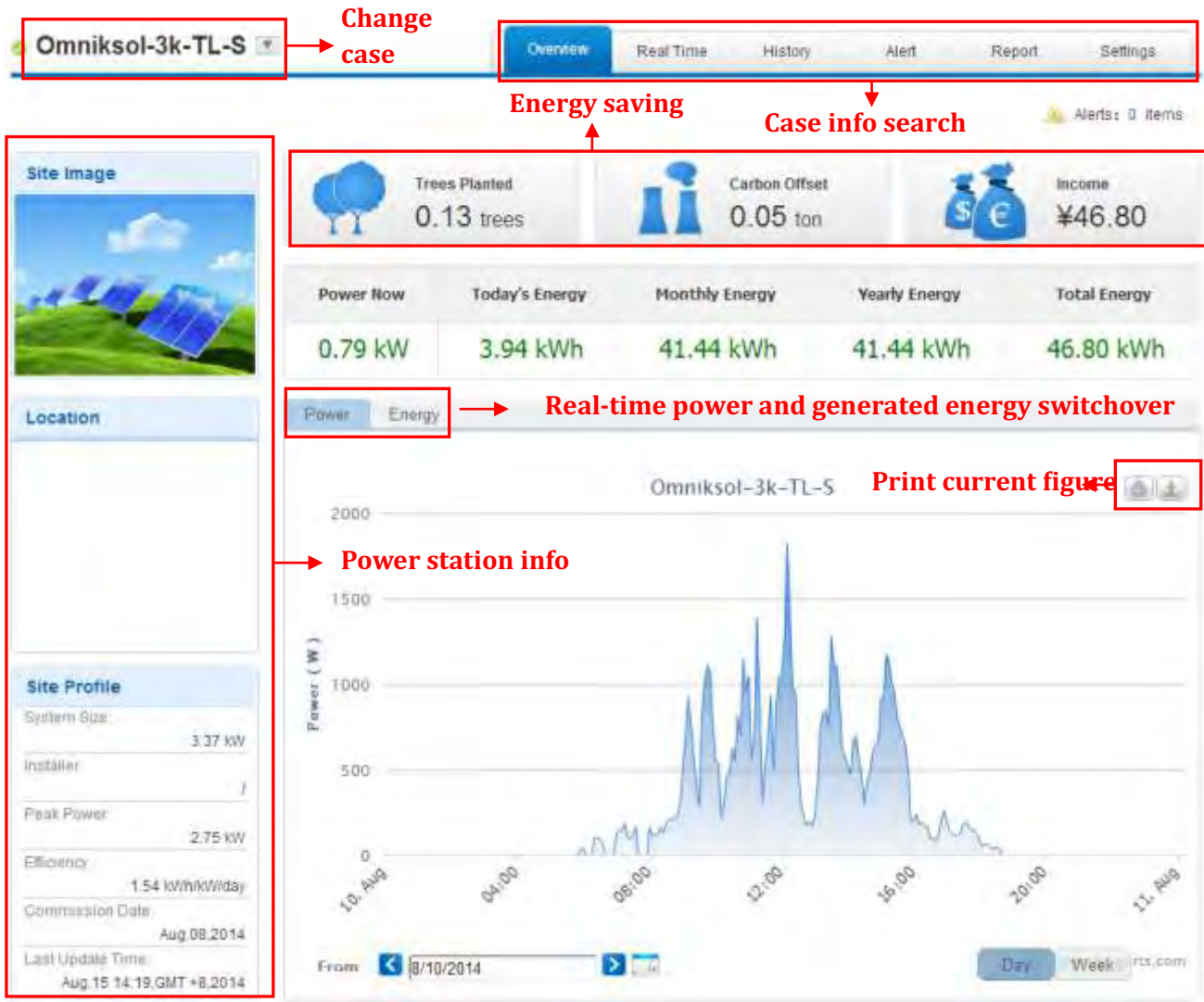
Головний інтерфейс електростанції
