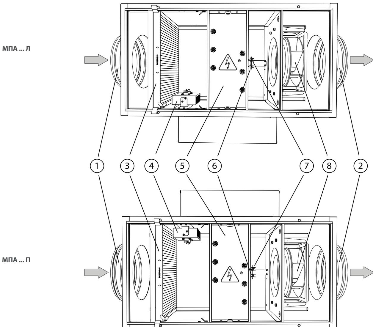
Агрегат забезпечує подавання підігрітого та відфільтрованого повітря з вулиці до приміщення.
