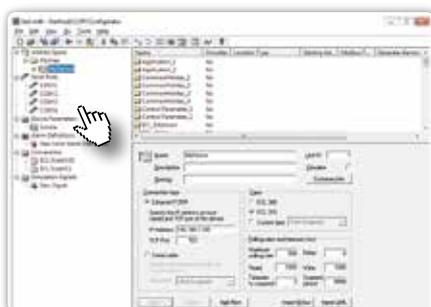
**OPC-Сервер** – программный продукт, который совместим с большинством SCADA-клиентов, и позволяет быстро подключить и произвести конфигурацию электронных регуляторов ECL Comfort 310, как части системы SCADA.
