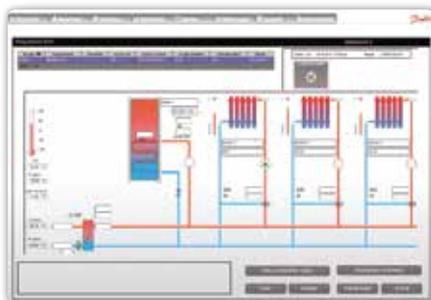
**DECS 2.0** – также простое в использовании веб-решение SCADA, предназначенное в основном для теплоснабжающих предприятий.
