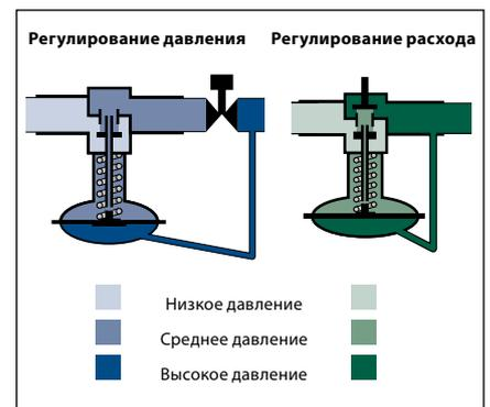
Низкий перепад давления ( $\Delta p$ ) на регулирующих клапанах, который обеспечивают автоматические регуляторы давления прямого действия «Данфосс», предотвращает появление кавитации и уменьшает шум в системе.
