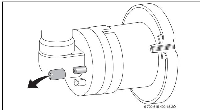
Мал. 51 Штуцер для вимірювання на змішувальній камері
