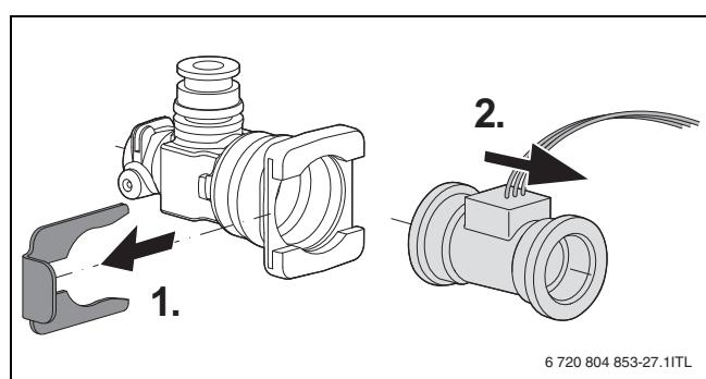
Мал. 64 Демонтаж турбіни на трубі холодної води
