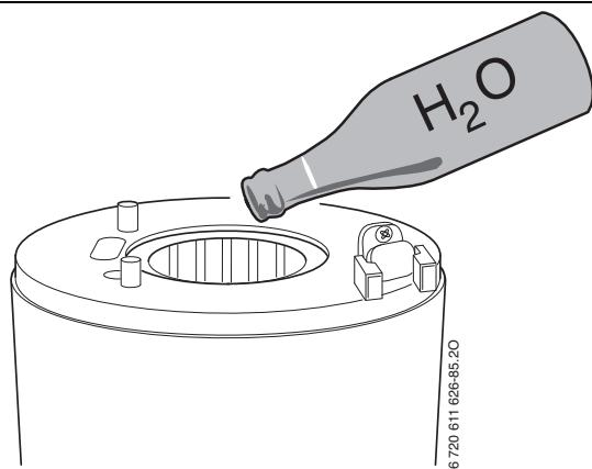
Мал. 59 Промивання водою котлового блока, який включає камеру згоряння і теплообмінник
