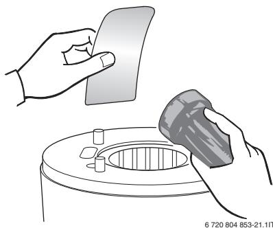
Мал. 58 Перевірка котлового блока, який включає камеру згоряння і теплообмінник, на наявність відкладень
