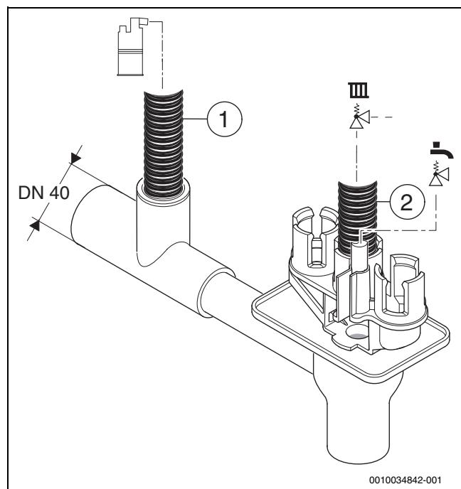
Мал. 25 Встановлення на сифон шланга для відведення конденсату та шланга запобіжного клапана
