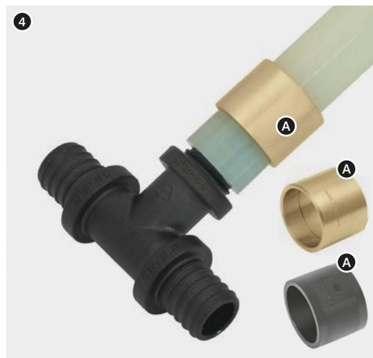
В случае чрезмерного расширения трубы во время выполнения соединения может произойти „выдавливание” материала трубы между фитингом и кольцом. Чтобы предотвратить эту ситуацию, следует закончить процесс натяжения кольца на трубу перед опорным фланцем (следует удерживать зазор около 2 мм до фланца соединителя).
