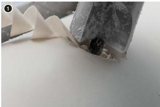
2. Обработка отверстия - удаление заусениц, возникших после просверливания.
