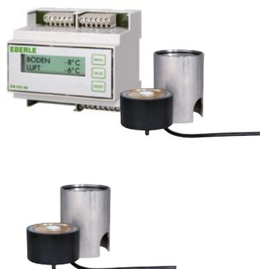
**Контроллер обледенения открытых площадок с датчиком наружной температуры и с датчиком снега и льда** – при взаимодействии с системой подогрева открытых поверхностей защищает от обледенения, а также от залегания снега на коммуникационных трассах (лестницы в уличных переходах, тротуары, автостоянки, подъездные пути и т.п.).
