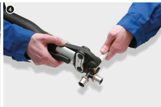
4. Разместить пресс-клещи на стальном кольце между пластмассовым дистанционным кольцом и фланцем стального кольца перпендикулярно к оси штуцера соединителя (пресс-клещи типа „U”). В случае профиля обжима „ТН” пресс-клещи следует позиционировать на пластмассовом дистанционном кольце (кольцо должно входить в паз пресс-клещей).
