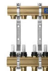
распределитель с профилем 1" для панельного отопления с регулирующими вентилями - (нижняя часть распределителя) и с вентилями для сервоприводов (верхняя часть распределителя) (серия 71A)
