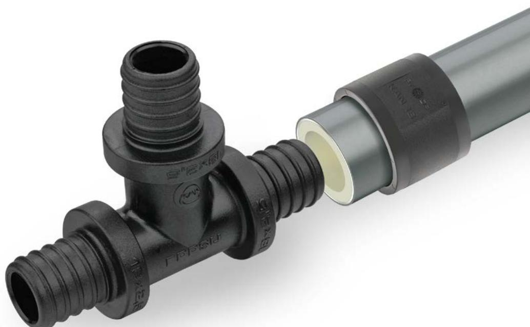
Герметичность безоринговых соединений в Системе KAN-therm Push Platinum достигается за счет натягивания полимерного кольца на трубу, в которую вставлен фитинг. Соединение не требует дополнительного уплотнения типа тефлоновой ленты, пакли. Дополнением Системы KAN-therm Push являются распределители и монтажные шкафчики, которые можно найти в разделе Система KAN-therm - распределители, шкафчики, дополнительные элементы.
