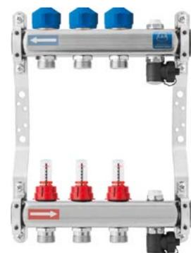
**распределитель 1 ¼" из нержавеющей стали с расходомерами и вентилями для сервоприводов M30x1,5 (серия N75E) без воздуховыпускного клапана**
