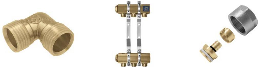
Большим преимуществом конусных соединений является их самоуплотнение после свинчивания. Соединения этого типа - самоуплотняющиеся, не следует применять дополнительное уплотнение в виде тефлоновой ленты или пакли. Соединения должны иметь возможность доступа.
