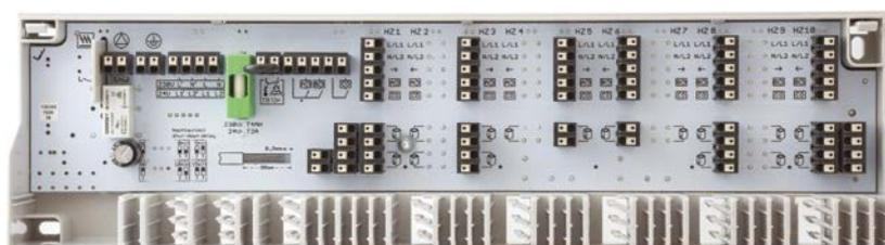
**Клеммные колодки Basic+** обеспечивают питанием все элементы управления. Доступны в версии отопление – охлаждение с возможностью управления 6 или 10 зонами отопления, а также в исполнении 230 В и 24 В (необходим трансформатор 230/24 В AC). Клеммные колодки могут управлять работой котла и циркуляционным насосом. Дополнительно их можно перенастроить для работы с сервоприводами NC (нормально закрыт) или NO (нормально открыт).
