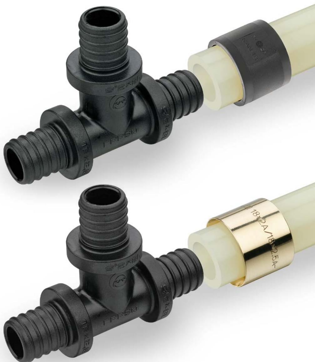
Герметичность безоринговых соединений в Системе KAN-therm Push достигается за счет натягивания латунного или полимерного кольца на трубу, в которую вставлен фитинг. Соединение не требует дополнительного уплотнения типа тефлоновой ленты, пакли. Дополнением Системы KAN-therm Push являются распределители и монтажные шкафчики.
