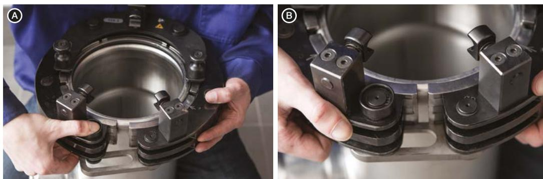
Раскрытыми пресс-клещами обхватить фитинг. Пресс-клещи имеют специальную выемку, которую необходимо подогнать к выпуклой части фитинга. После правильного закрепления пресс-клещей на фитинге, необходимо их снова зафиксировать, путем повторного нажатия на кнопку блокировки и застегивания защелки.
