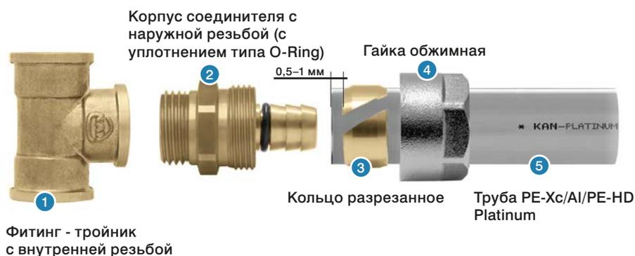
Разрезанное кольцо надевается на трубу так, чтобы край кольца отступал от края трубы на 0,5 - 1 мм. Труба должна быть насажена до конца корпуса соединителя. Это соединение можно трактовать, как разъемное, при условии, что после демонтажа, а именно после извлечения корпуса соединителя из трубы, использованный конец трубы будет отрезан и будет выполнено новое соединение.
