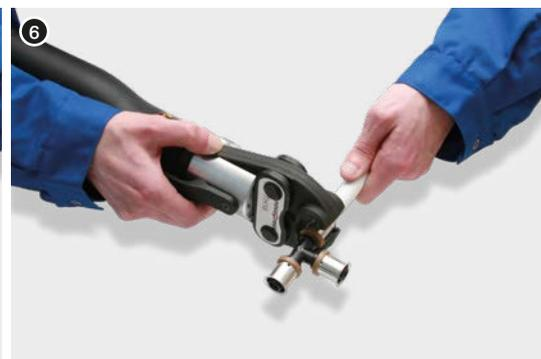
6. После выполнения соединения разблокировать пресс-клещи и снять их с обжатого кольца. Соединение готово для испытаний давлением.
