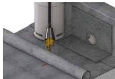
9. Уложить второй слой битумной гидроизоляции до парапета и приварить его
