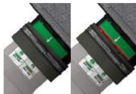
6. Отводящую трубу вставить в корпус до тех пор, пока красная полоса не скроется
