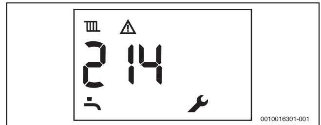
Мал. 76 Приклад: несправність, що не призводить до блокування
