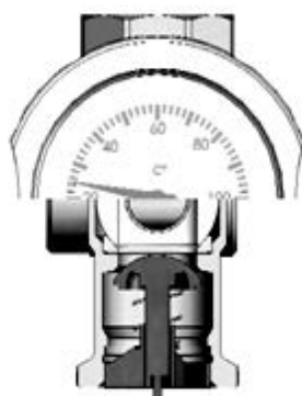
Шаровой кран открыт, обратный клапан в автоматическом режиме.
