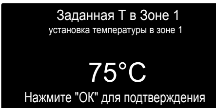
Изменение температуры горячей воды отопления
