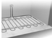
Вирізьте канали для кабелів живлення, холодних дротів і датчика температури в стіні та підлозі (Увага! Холодні дроти та кабель датчика мають бути змонтовані в двох окремих гофрованих трубках!).
