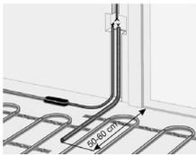
Кабель датчика температури підлоги необхідно прокласти в окрему трубку відповідно до EN 61386-1. Його слід розташувати на рівні нагрівання безпосередньо під нагрівальним матом, організувавши штробу в підлозі. Датчик повинен бути розташований по центру між двома нагрівальними
