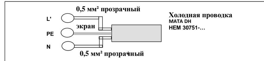
Подключение нескольких нагревательных мат производится параллельно! Максимально допустимый ток регулирующего устройства должен быть соблюден!
