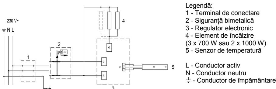
Fig. 5: Instalația electrică
