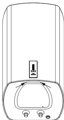
Перед подключением к электросети необходимо к водонагревателю необходимо подключить соединительный шнур с минимальным сечением  $1,5 \text{ мм}^2$  (H05VV-F 3G  $1,5 \text{ мм}^2$ ). Для этого следует снять предохранительную крышку. Между водонагревателем и сетью электропитания должно быть предусмотрено соответствующее национальными стандартами монтажа электроустановок устройство, позволяющее полностью отключить прибор от сети.
