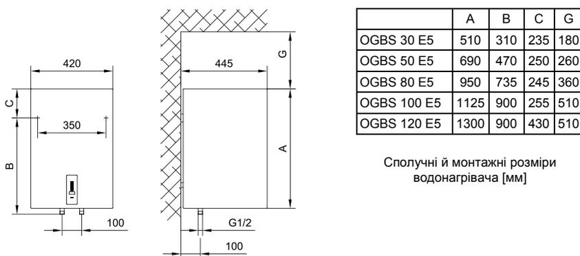
Сполучні й монтажні розміри водонагрівача [мм]
