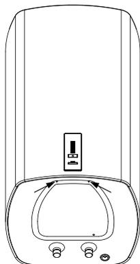
Înainte de conectarea la instalația electrică, este necesar să se monteze un cablu de legătură cu secțiunea minimă de 1,5 mm<sup>2</sup> (H05VV-F 3G 1,5 mm<sup>2</sup>). De aceea, trebuie să înlăturați capacul de protecție. Dispozitivul de separare a polilor din instalația electrică trebuie să corespundă normativelor în vigoare la nivel național.
