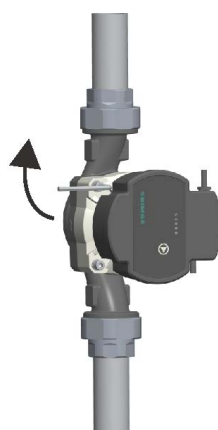
5) Відрегулювати в потрібному напрямку, зафіксувати шестигранними болтами
