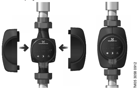
Рис. 8 Изоляция корпуса насоса
