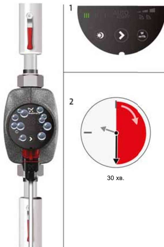
Рис. 8 Видалення повітря з насоса
