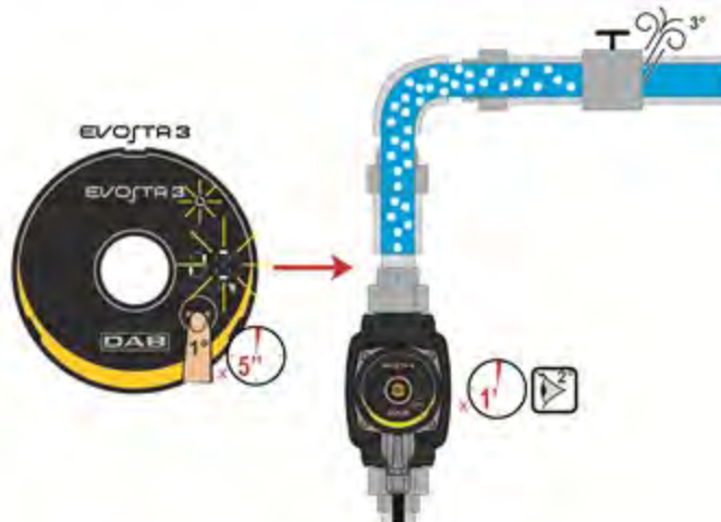
Фигура 9: Автоматично обезвъздушаване на помпата
