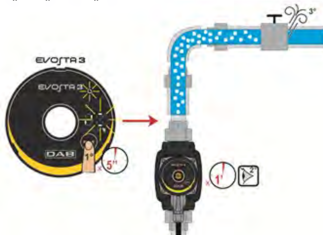
Fig. 9: Automatisk udluftning af pumpe
