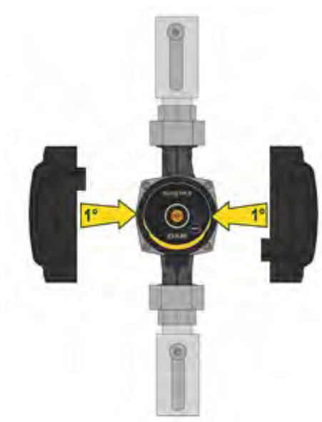
Obrázok 7: Izolácia telesa čerpadla
