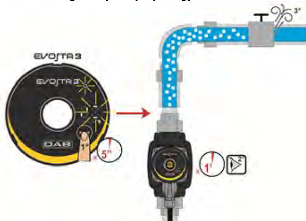
9. ábra: A pumpa automatikus légmentesítése
