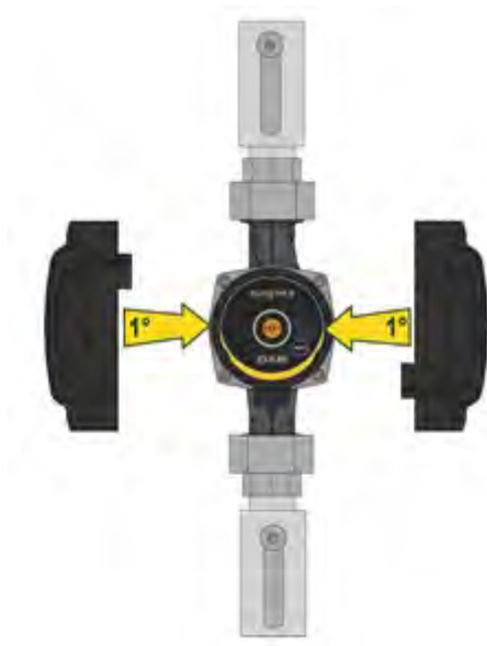
Abb 7: Isolierung des Pumpenkörpers
