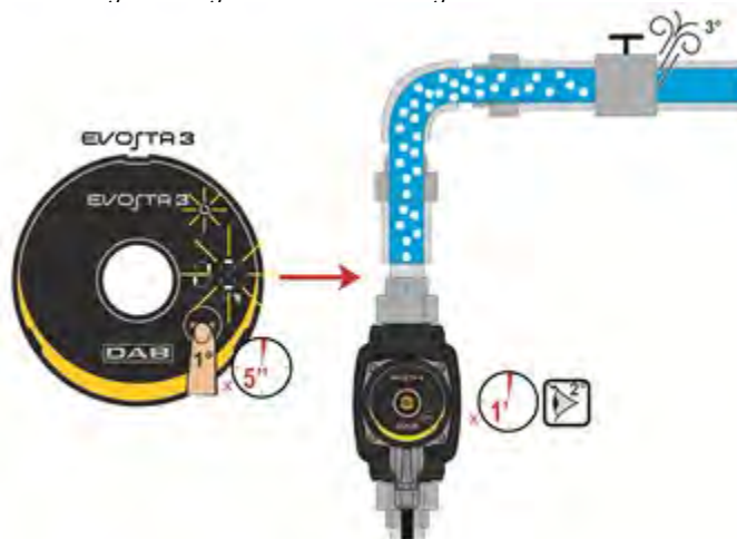
Afbeelding 9: Automatische ontluchting van de pomp
