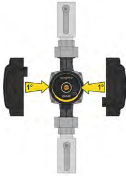
الشكل 7: عزل جسم المضخة
