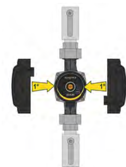
Rysunek 7: Izolacja korpusu pompy
