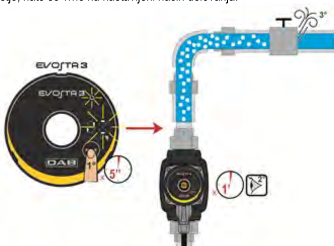
Slika 9: Avtomatska odzračitev črpalke
