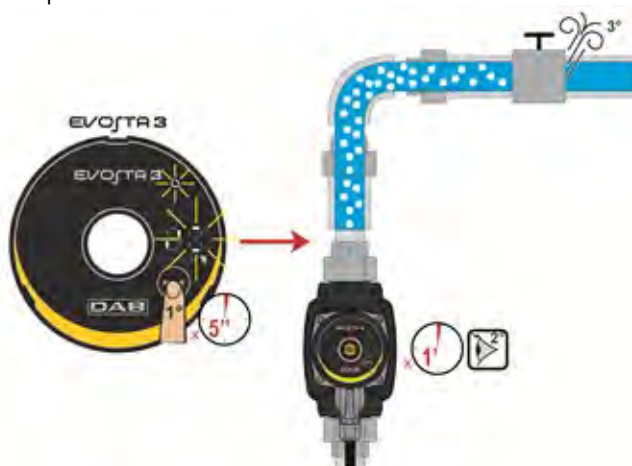
Рисунок 9: Автоматическое удаление воздуха из насоса
