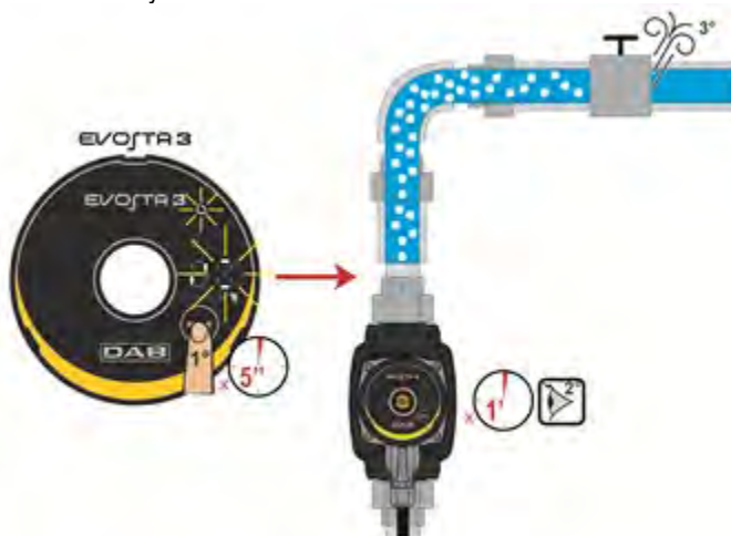
Obrázek 9: Automatické odvzdušnění čerpadla
