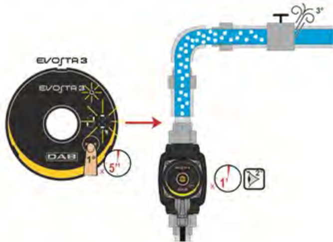
الشكل 9: التنفيس التلقائي للمضخة
