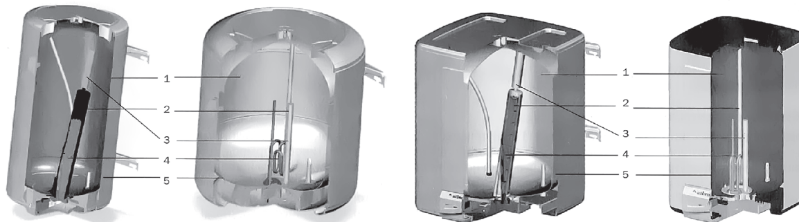
1. Внутрішній бак з емалевим покриттям
