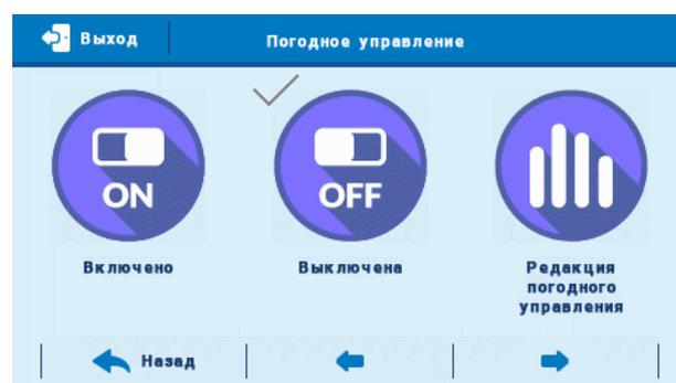
Для настройки заданной температуры нужно нажать соответствующий пункт и переместить вверх или вниз (с левой стороны отобразится определённая температура клапана), затем стрелками или выбрать желаемую температуру. На дисплее отобразится настроенная нами кривая отопления.
