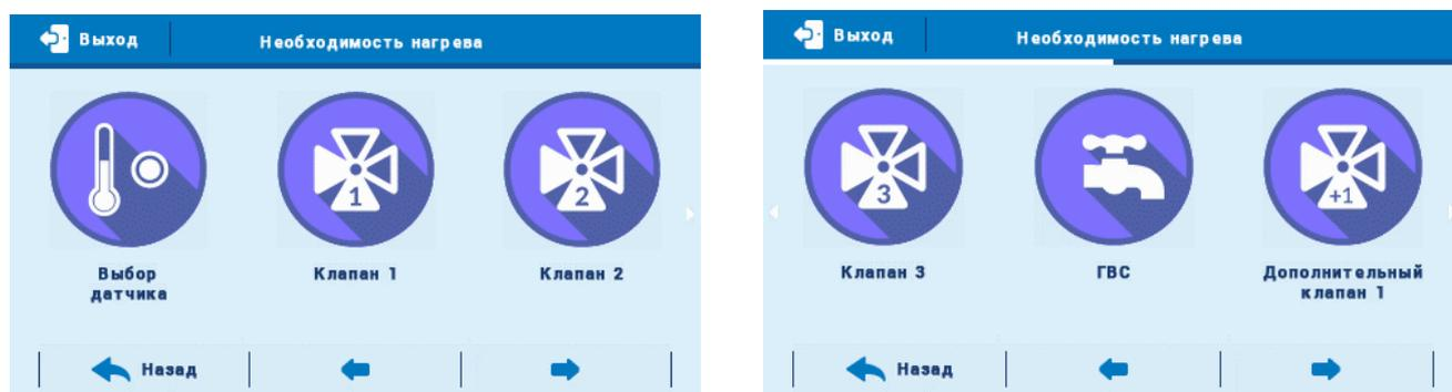
Если температура на датчике будет ниже заданной температуры выбранного клапана (пользователь может выбрать одновременно несколько клапанов), устройство будет включаться для обогрева клапана.
