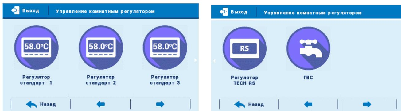
Чтобы работа устройства зависела от сигнала больше чем одного комнатного регулятора – устройство будет выключаться только тогда, когда все комнатные регуляторы сообщат обогретость. После обозначения опции ГВС включение и отключение устройства подключенного к дополнительному стыку будет зависимо от бойлера – когда бойлер достигнет заданную, устройство выключится.
