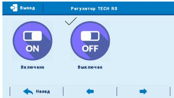
При установленном комнатном регуляторе TECH (с RS коммуникацией) пользователь кроме комнатного управления может изменять: заданные температуры активных клапанов, бойлера прямо из комнатного регулятора. Доступ к истории температур в виде легко читаемых графиков, сигнализация всех тревог контроллера, просмотр наружной температуры, возможность установления недельной программы являются дополнительными преимуществами устройства.
