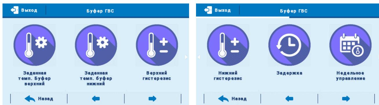
Кроме того, пользователь может установить работу этого устройства в соответствии с недельной программой (подробно описано в разделе 9), которая управляет заданной температурой верхнего датчика. Пользователь может устанавливать датчик, который будет работать в качестве верхнего и нижнего датчика.
