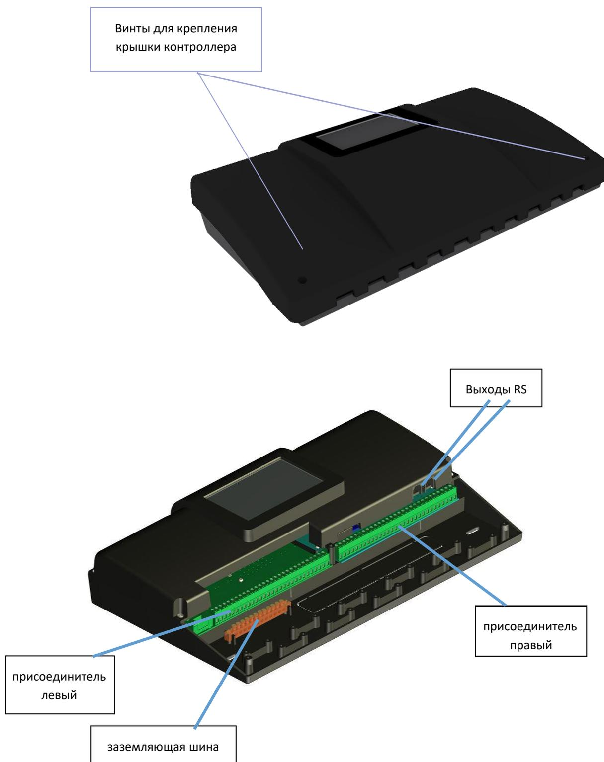
Наглядная схема — схема не может заменить проекта системы ЦО. Эта схема показывает возможности расширения контроллера. На схеме обогрвательной системы не показаны отключающие и защищающие элементы для выполнения ее профессионального монтажа.
