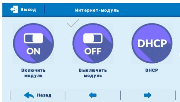
Поле включения интернет модуля и выборе опции DHCP, контроллер автоматически стянет параметры локальной сети такие как: IP-адрес, IP-маску, адрес шлюза, DNS-адрес. Если возникли проблемы с загрузкой сетевых параметров, можно их установить вручную. Способ получения параметров локальной сети описан в инструкции интернет модуля.
