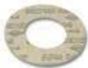
Уплотнение для фланца высокого давления, без асбеста, подходит для фланцев под сварку, резьбу, пресс, температурная устойчивость до макс. 400°C, устойчиво к воде, пару, топливу, разбавленной щелочи (проверено DVGW по DIN 3535 часть 6). Размеры согл. DIN EN 1514-толщина 1, 2 мм для фланцев. PN 10/16 = DIN EN 1092-1 и DIN EN 1092-2
