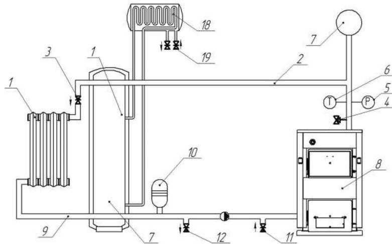
Рис. 3. Схема приєднання котла до системи опалення
