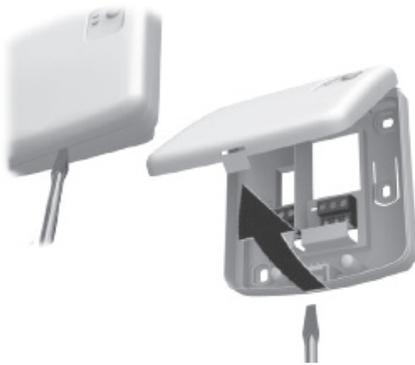
3 Monteer de bedradingsklemplaat op de wand of in de aansluitkast.
