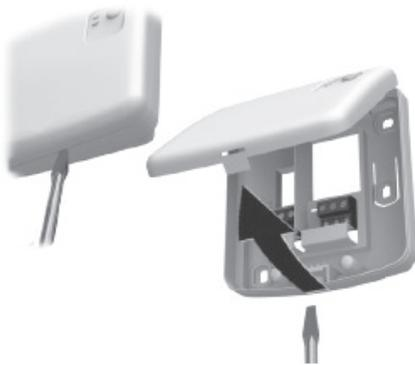
3 Monte la placa de cableado en la pared o en la caja de empotrar.
