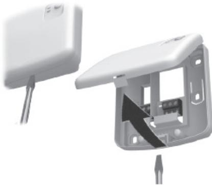
3 Monte a placa de ligações na parede ou na caixa embutida.
