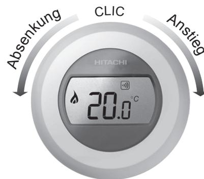
Nach fünf Sekunden wechselt die Anzeige wieder zur aktuellen Raumtemperatur. Das Thermostat versucht nun, die eingestellte Temperatur so genau wie möglich aufrecht zu erhalten. Prüfen der Einstelltemperatur: Wählring um einen "Klick" nach links oder rechts drehen. Dann blinkt der aktuelle Einstelltemperaturwert ein paar Sekunden lang und anschließend erscheint wieder die Raumtemperatur auf der Anzeige.
