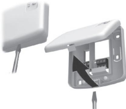
3 Montér ledningspladen på væggen eller vægboksen.
