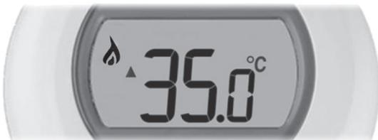
Während diese Einstellung blinkt, berühren Sie kurz den linken Touchscreen-Bereich, um die Mindesttemperaturgrenze anzuzeigen. Diese kann auch unter Verwendung des Einstellrings geändert werden.
