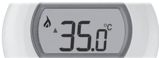
Lorsque le réglage clignote, touchez la zone gauche pour afficher la limite de température minimale. Cela peut également être modifié en utilisant le sélecteur.
