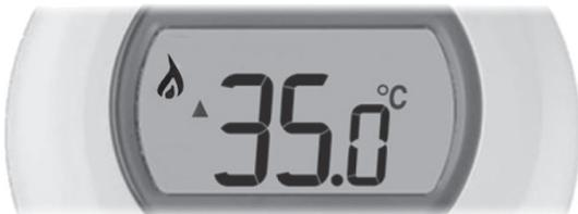
Mientras el ajuste parpadea, toque la zona izquierda para que se muestre el límite de temperatura mínima. También se puede modificar utilizando el aro selector.
