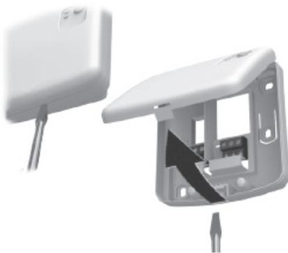
3 Die Verdrahtungsplatte an die Wand oder an die Wandbox montieren.
