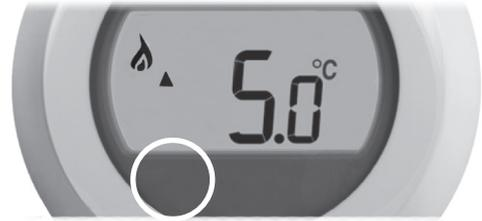
Ο θερμοστάτης δεν μπορεί να χρησιμοποιηθεί για ενεργοποίηση και απενεργοποίηση του συστήματος εκτός κι αν το όριο της ελάχιστης θερμοκρασίας ρυθμίζεται σε μια τιμή κάτω από 10 °C, για παράδειγμα 5°C.
