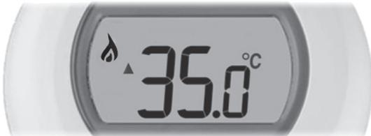
Enquanto este ajuste pisca, toque brevemente na zona tátil esquerda para visualizar o limite de temperatura mínimo. Também pode executar isto com o anel seletor.
