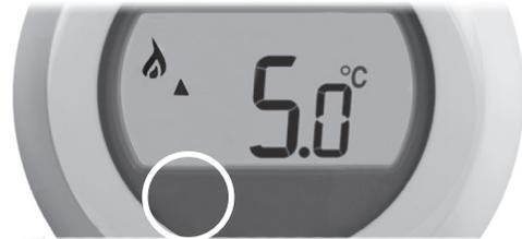
Das Thermostat kann nicht für das Ein- oder Ausschalten der Anlage verwendet werden, außer, die Höchsttemperatur ist auf einen Wert unter 10 °C eingestellt (z. B.: 5 °C)
