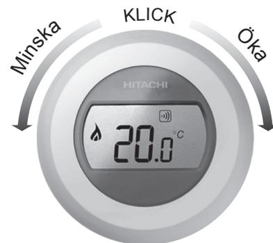
Displayen skiftar tillbaka till att visa aktuell rumstemperatur igen efter 5 sekunder. Sedan försöker termostaten att bibehålla den inställda temperaturen med så stor noggrannhet som möjligt. Den inställda temperaturen kan kontrolleras genom att vrida ringen ett "klick" åt höger eller vänster. Den kommer att visas under några sekunder innan den återgår till att visa rumstemperaturen.
