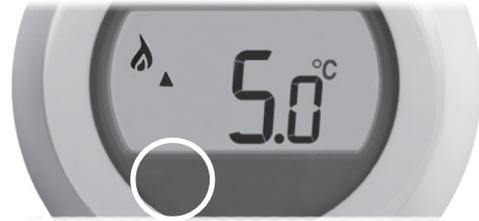
O termóstato não pode ser utilizado para ligar e desligar o sistema exceto se o limite para a temperatura mínima for inferior a 10 °C (p. ex.: 5 °C).
