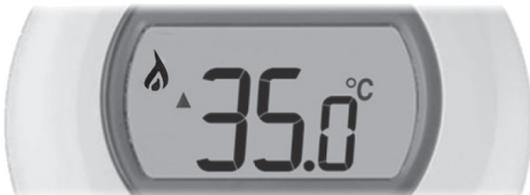
Druk, terwijl de waarde knippert, kort op de linkerkant om de minimumtemperatuur te zien. U kunt deze wijzigen met de instelring.
