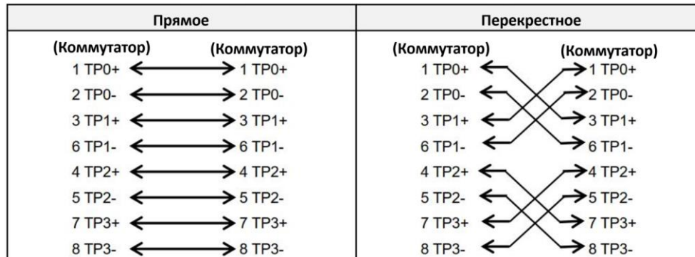
Рисунок 7-1 Соединение четырех витых пар
