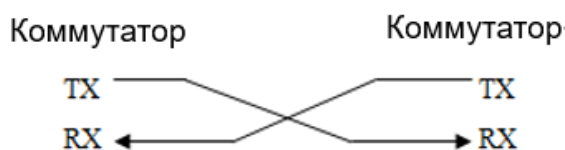
Рисунок 7-4 Соединение волоконно-оптического кабеля
