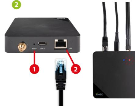
Переконайтесь, що пристрій підключено до джерела живлення та Інтернету через кабель (2). Потім натисніть і утримуйте кнопку RESET (1) (за допомогою шпильки з комплекту) протягом 10 секунд. Червоний світлодіод повинен повільно блимати, тоді шлюз знаходитьться в режимі сполучення. Якщо червоний світлодіод швидко блимає, знову натисніть кнопку RESET протягом 10 секунд, зачекайте трохи та переконайтесь, що червоний світлодіод блимає повільно.
