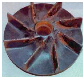
Повреждение крыльчатки насоса
