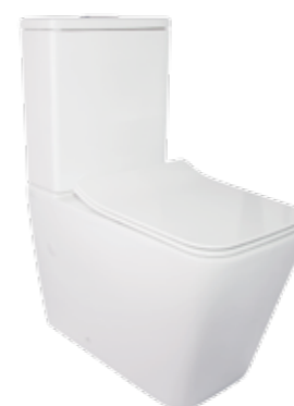
QT05222170W Унітаз підлоговий Rimless гор. випуск, сидіння Slim Duroplast/ Soft-close/ Quick release бачок 3/4.5L. див. с. 195
