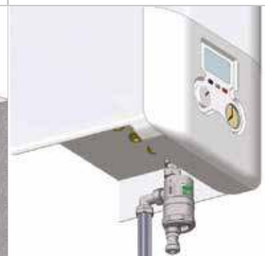
Пример установки грязеуловителя COMPACTFAR с угольником (5304), под настенным котлом
